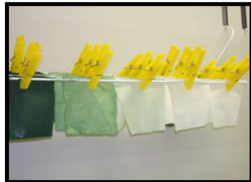
Fig. 7 - Campioni di tessuto impregnati con polianilina in acqua
