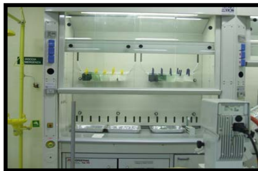
Fig. 8 - Campioni impregnati con polianilina in acqua (a sinistra) e in xilene (a destra)
